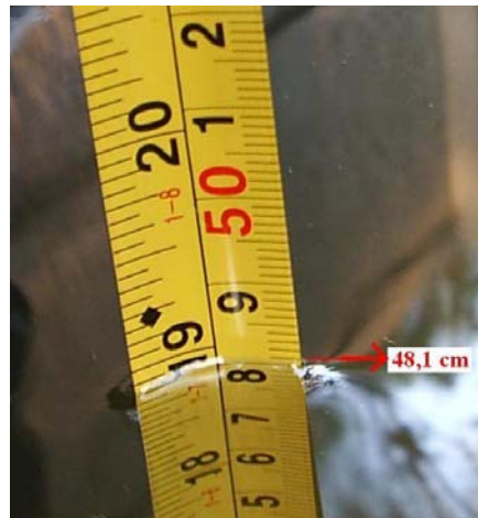
Figura 11: tomada fotográfica mostrando em detalhe a medida de 48,1 cm (profundidade de referência na cisterna).
