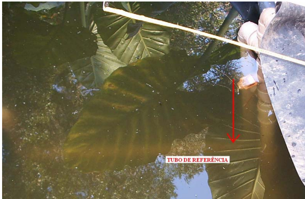
Figura 6: tomada fotográfica mostrando a posição do tubo de referência no fundo da cisterna para medição do nível da água (seta vermelha).
