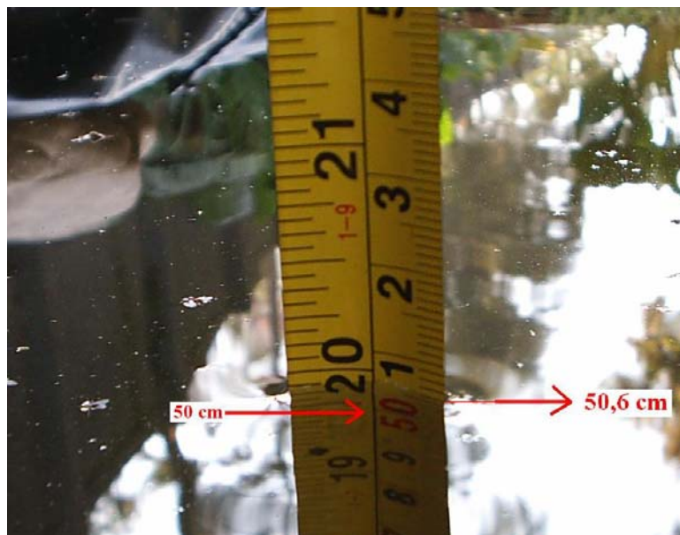
Figura 7: tomada fotográfica mostrando em detalhe a medida de 50,6 cm na cisterna.
